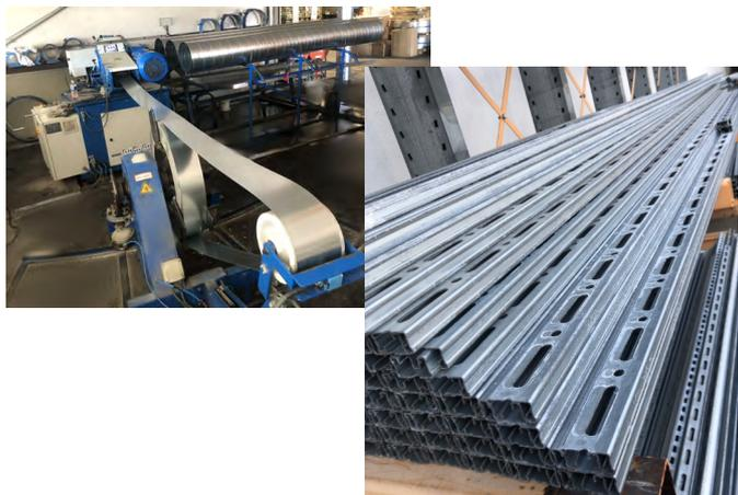
Fabrication des gaines circulaires et rail de supportage
